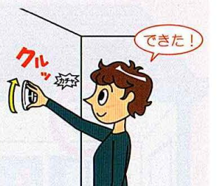
④ 取り付けた板に本体を はめます。 これで取り付け完了です。
