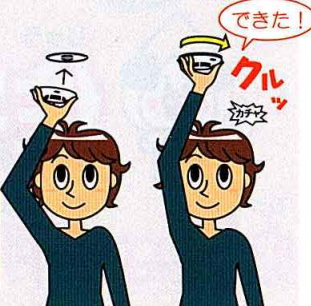
④ 取り付けた板に本体を はめます。 これで取り付け完了です。
