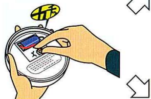
② 本体に付属している電池のコネクタを差し込みます。 (これで電源が入ります。) ※コネクタのない機器もあります。
